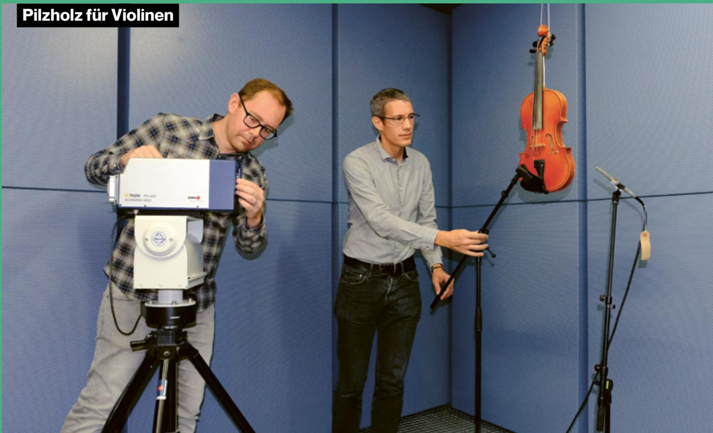
Körperschallmessungen der Pilzgeigen im Labor der Empa.
